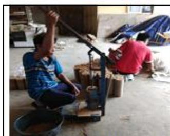
Gambar 1. Penggunaan Mesin Press Manual untuk pengepressan baglog jamur
